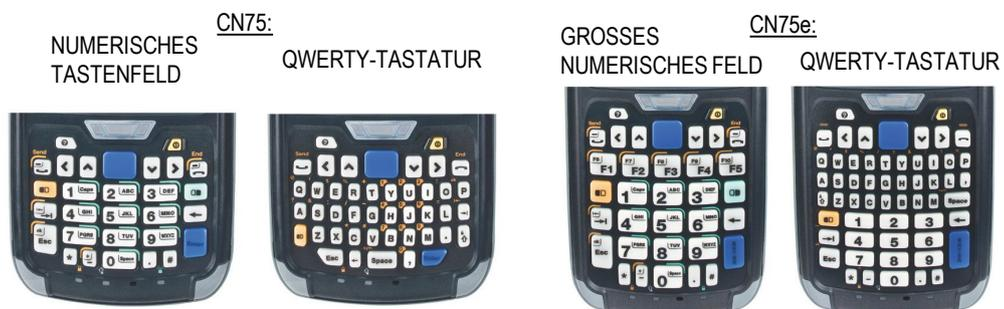
Alle Tastaturoptionen sind mit robusten Tastenkappen mit lasergravierter Beschriftung und Hintergrundbeleuchtung ausgestattet
